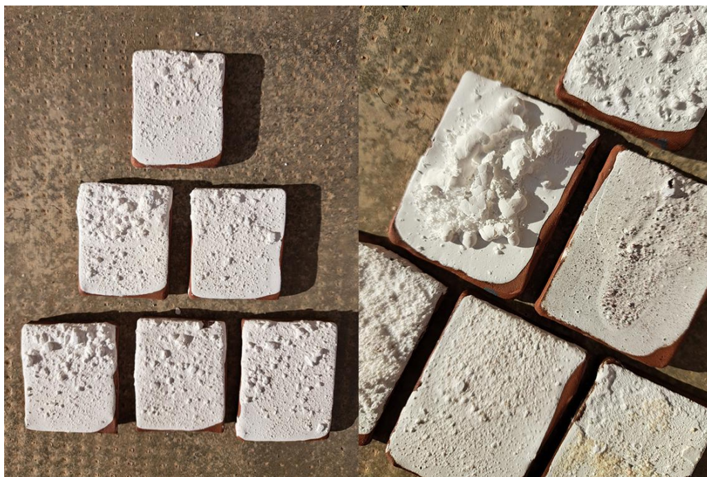
Figure 10. Tessons émaillés sur grès orangé (1200°C) – Echantillons de A à F (à droite) et G à L (à gauche).
