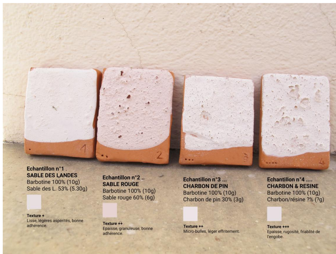
Figure 9. Tessons engobés de grès orangé – Echantillons n°1 à 4.
