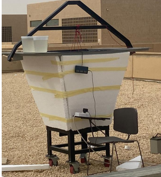
Figure 2. Prototype expérimental d'un étang solaire à gradient de sel
