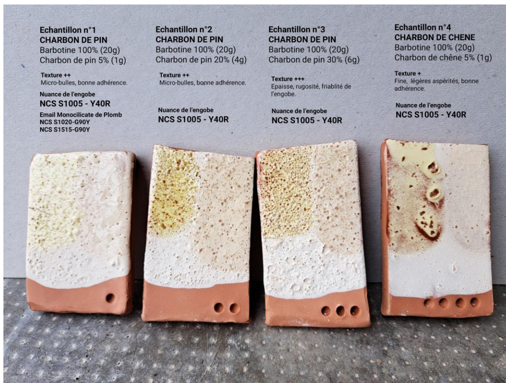
Figure 7. Tessons de faïence rouge n°1 à n°4. Détails des recettes.
