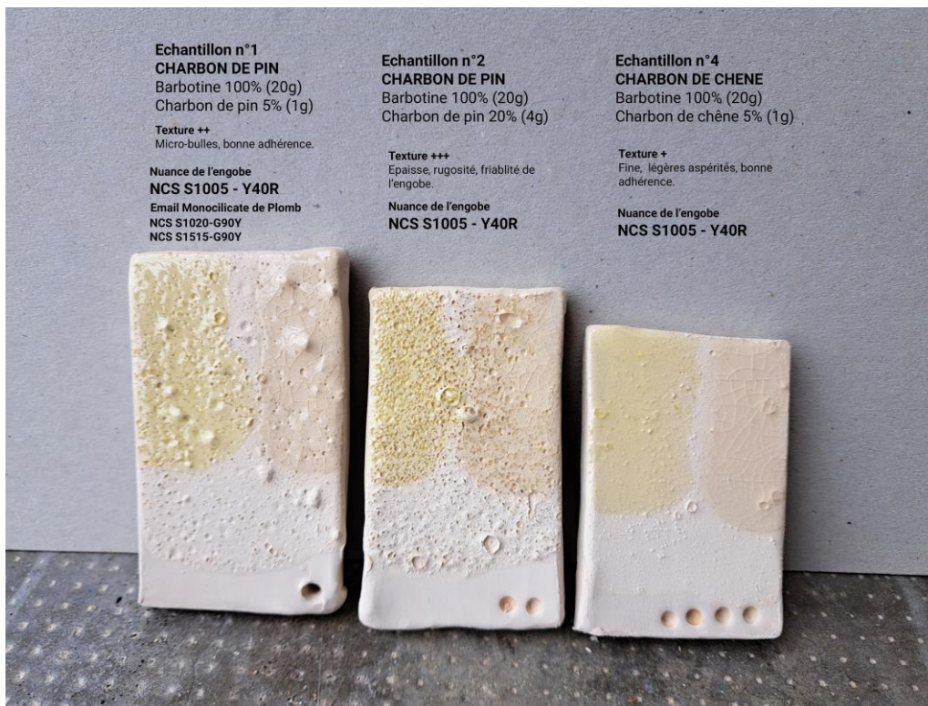
Figure 6. Tessons de faïence blanche n°1, n°2 et n°4. Détails des recettes.
