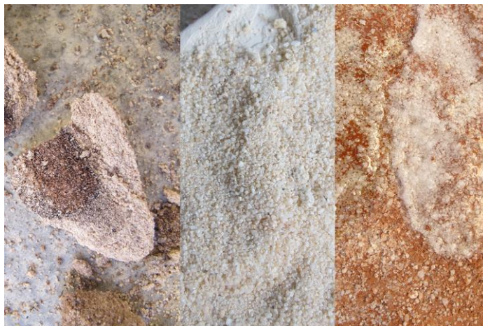
Figure 11. De gauche à droite : (1) Etat naturel du sable récolté sur site. (2). Sable après cuisson à 1030°C. (3). Tests : mélange de fritte et de sable sur tesson de faïence rouge.
