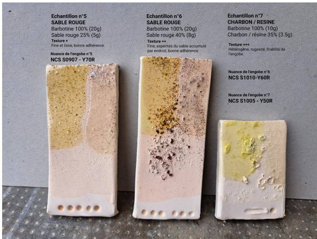
Figure 8. Effets du sable rouge : tessons de faïence blanche n°5 à 7. Détails des recettes.
